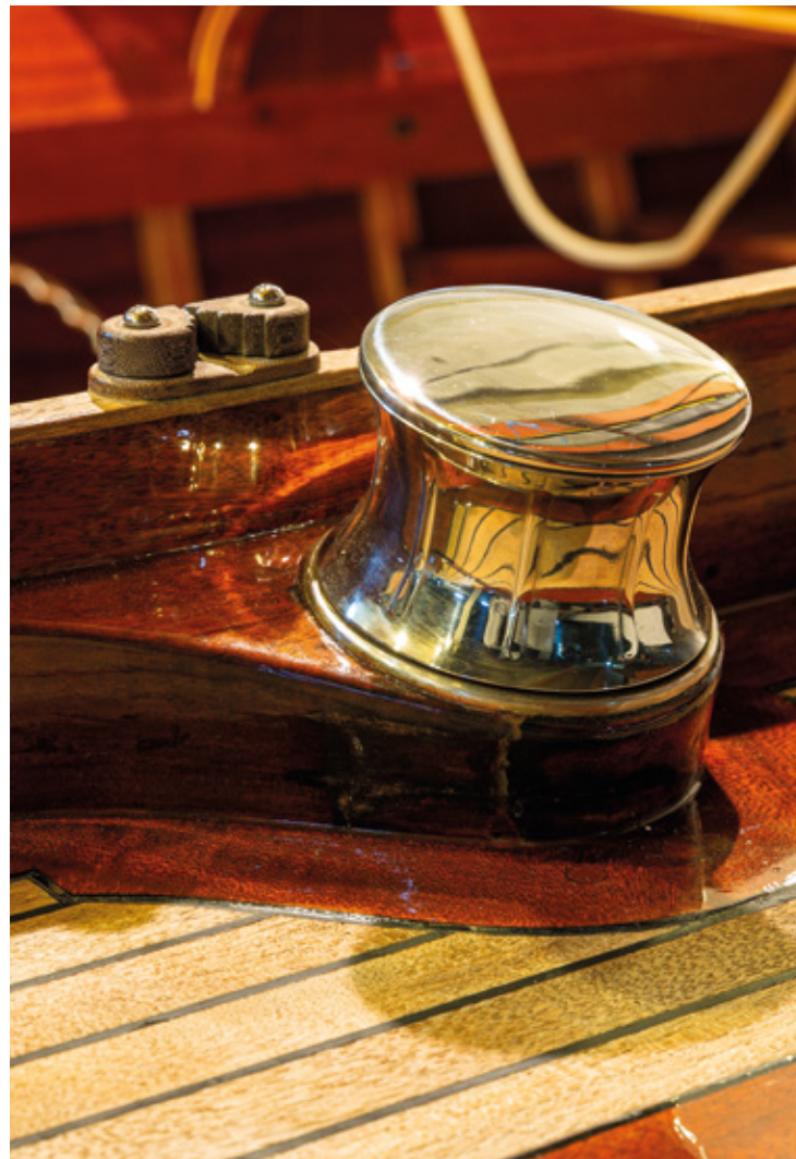
Oben: NESSIE erstrahlt in neuem Glanz. Der neu gebrachte 1K-Lack verspricht mehr Elastizität und sollte Risse im Freibord vorbeugen. Unten links: Spieglein, Spieglein an der Wand... Die originalen Andersen-Winschen verrichten ihren Dienst nach beinahe 50 Jahren noch einwandfrei. Unten rechts: Das Kajütendach war instabil geworden und musste ausgesteift werden. Durch einen neuen Träger erhielt die Konstruktion ihre Festigkeit zurück. Dazwischen die Achse der Spinnaker-Winsch, ein eher seltener Anblick bei einem Drachen.
