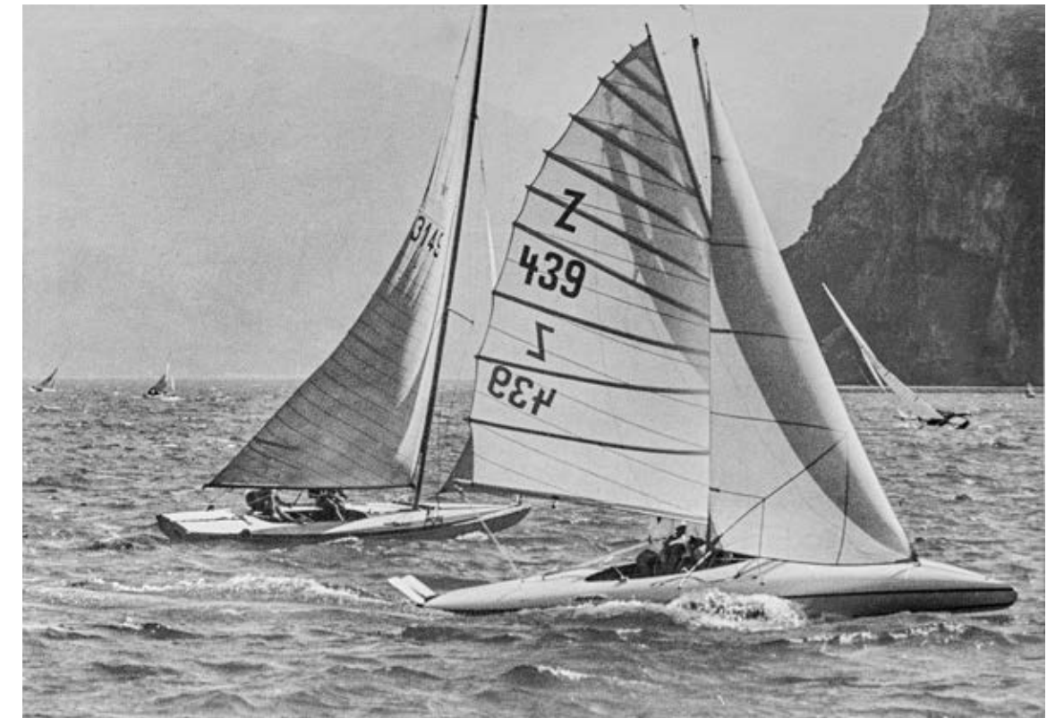
AERO II, seine Z-Jolle in Leichtbauweise die nach seinen Plänen gebaut wurde.
