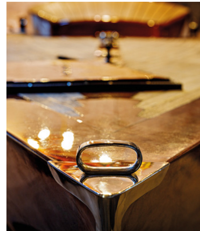
Der alte Bugbeschlag war nicht mehr zu retten. Hans-Joachim Landolt zauberte jedoch aus dem alten Auge und viel Liebe zum Detail einen neuen Bugbeschlag für NESSIE.
